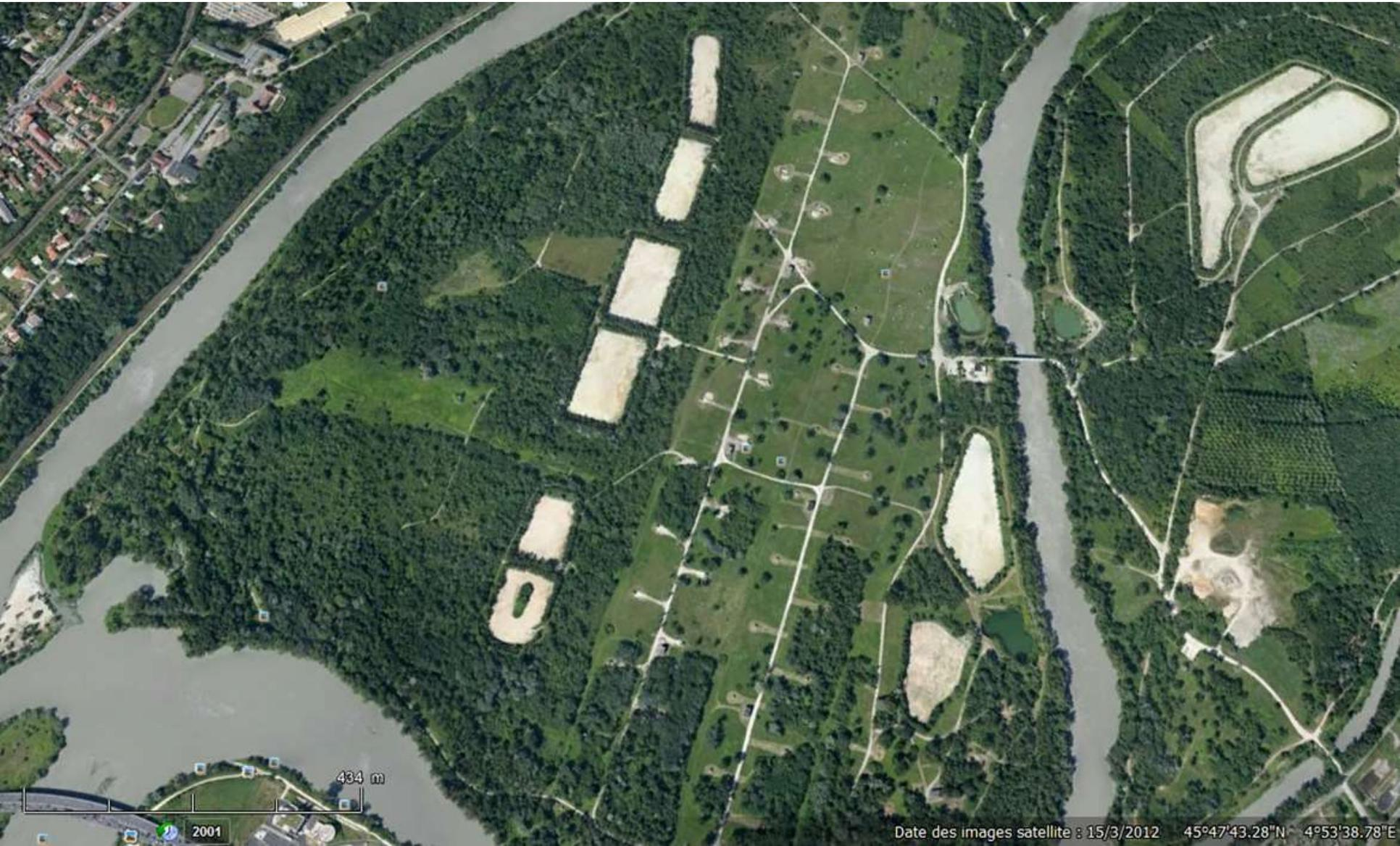
L'eau de la Métropole de Lyon provient essentiellement des **nappes phéatiques** et captée dans la zone de Crépieux-Charmy. Ce champ captant est l'un des plus vastes d'Europe. Il est situé en limite nord de Lyon et abrite **114 puits qui fournissent 95 % de l'eau consommée** : 600.000m<sup>3</sup>/jour avec un potentiel de 1.000.000m<sup>3</sup>/jour
